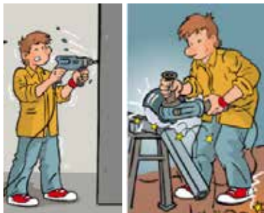
Risiko for støv i øynene, risiko for kutt, rifter, flygende partikler og brann.
